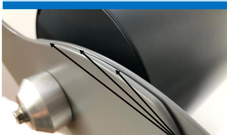
Achten Sie unbedingt darauf, dass die Rotorblätter direkt übereinander liegen. Abweichungen bedeuten eine Unwucht und führen zu lauten Geräuschen und oder Materialschäden.
